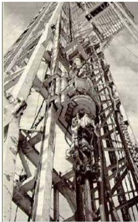
Figura 2.15: impianto di Perforazione – Top Drive System
